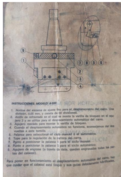
Ref. 280/V188 Cabezal mandrinar CONIC A-200 Cono morse-3. Rango de desplazamiento 35 mm. Avance automático. Precio 200 €
