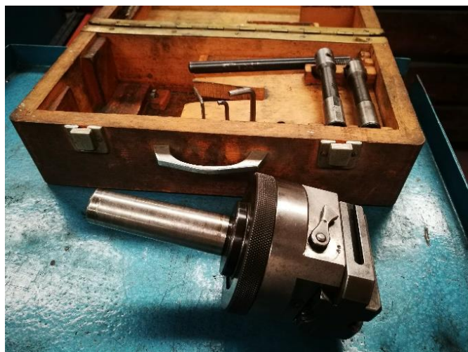
Ref. 280/V188 Cabezal mandrinar CONIC A-200 Cono morse-3. Rango de desplazamiento 35 mm. Avance automático. Precio 200 €
